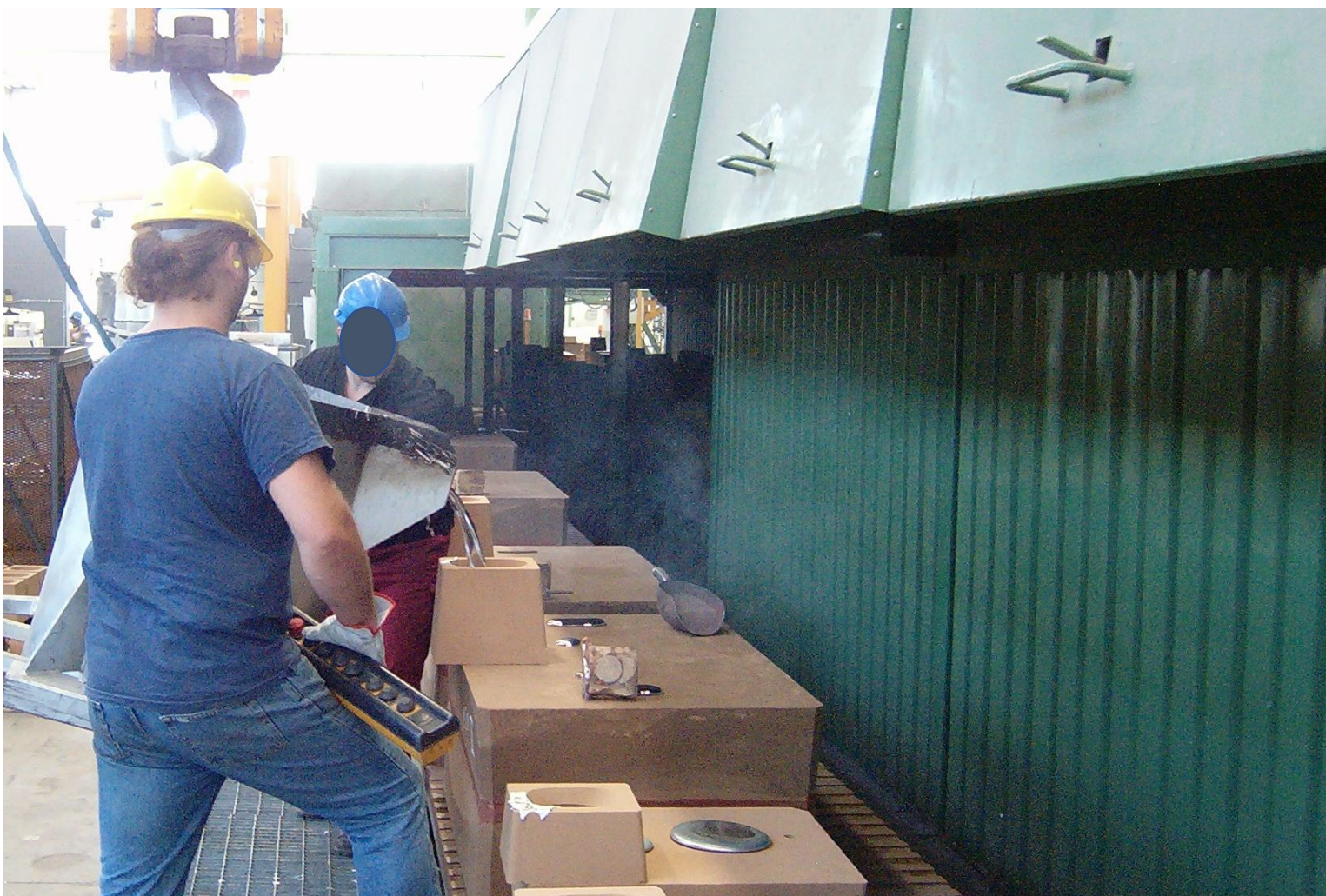
Colata e raffreddamento in zone aspirate correttamente
